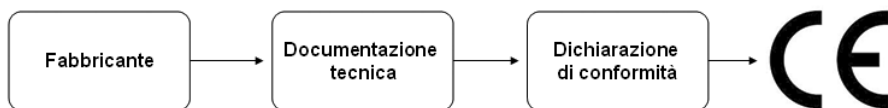
Diagramma di flusso MODULO A: Controllo interno della produzione per la valutazione della conformità del materiale elettrico a bassa tensione
